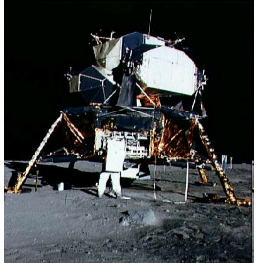
LUNÁRNÍ MODUL Apolla 11 - malá kosmická loď z projektu Apollo speciálně určená k přistání na Měsíci, ubytování astronautů a ke startu zpět na oběžnou dráhu Měsíce.
